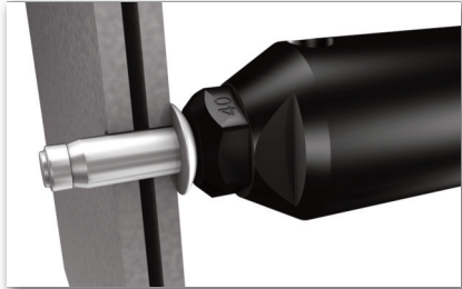
Andrückkontrolle für ein sicheres Fügen ohne Stauchen des Nietes zwischen den Bauteilen
