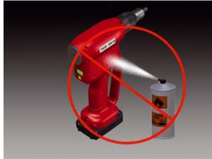
Reinigen Sie die Kontakte des Akkus und der Akkuaufnahme am Werkzeug bei Bedarf mit einem Tuch, Wattestäbchen und etwas Alkohol.
