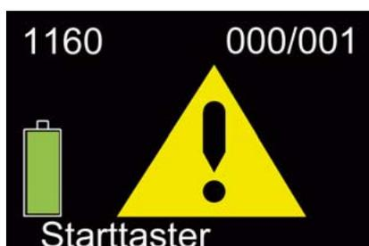
Werkzeug wurde erfolgreich gestartet. Durch kurze Betätigung des Starttasters fährt das Gerät in seine Ausgangsposition und prüft das Gerät auf Funktionstüchtigkeit. Anschließend ist das Gerät betriebsbereit.
