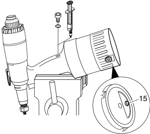
➔ **Hinweis** Bevor Sie Hydrauliköl einfüllen, müssen Sie das Hydraulikteil entlüften (siehe „Hydraulikteil entlüften“ auf Seite 29)
