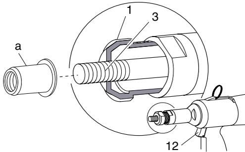
➔ **Hinweis** Gewindedorn (3) mit säurefreiem Öl benetzen, damit sich die Blindnietmutter leicht auf- und abschrauben lässt
