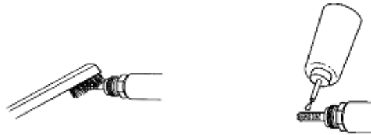
Abbildung 14: Ziehborn reinigen und schmieren
