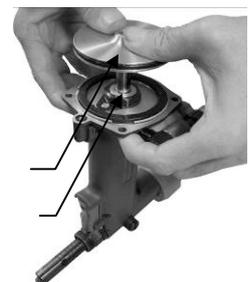
12. Wenn keine Luftblasen mehr aufsteigen, Hydrauliköl bis zur Höhe des Stützrings (19) in die untere Manschette (51) füllen.
