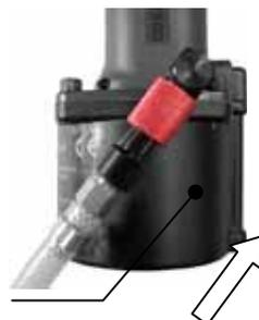
**Luftzufuhr AUS:** Roten Schiebeverschluss nach unten schieben, um das Ventil zu schließen.
