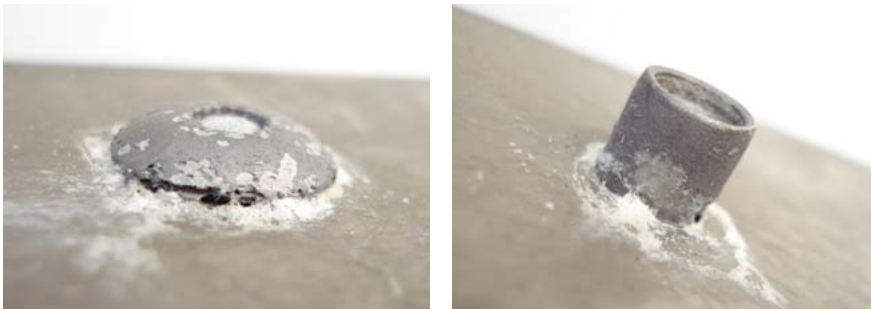
Auswirkungen Lochfrass nach 240 Std. Salzsprühnebeltest
