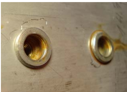
Blindnietmutter aus A2, verarbeitet mit Gewindedorn aus Schwarzstahl
