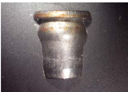
Spaltkorrosion bei einer Nietmutter aus A2 (1.4567)
