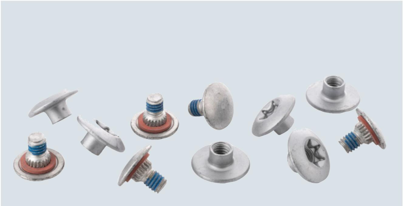
Der TI-TAINER ist ein zweiteiliges Verbindungssystem, das aufgrund seiner großen Kopfdurchmesser, der Verdrehsicherung am Bolzen und einer zusätzlichen Dichtung unter dem Bolzenkopf insbesondere für die sichere Befestigung von Bauteilen an weichen Platten, wie z. B. Plywood, ausgelegt ist. Zur Befestigung von Profilen und Scharnieren ist der TI-TAINER bestens geeignet.
